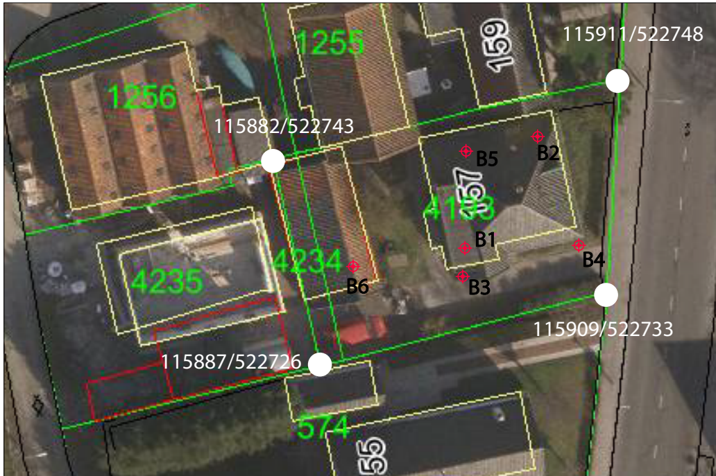
Afbeelding 14: Het boorgrid op een luchtfoto met daarop de projectie van de kadastrale uittreksel.
